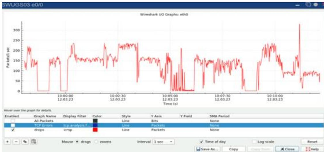
**Fig. 12-** Drops no circuito entre o SWUGS\_03 e SWUGS\_01.
