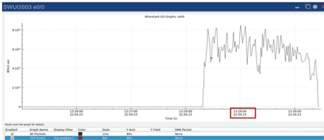
**Fig. 14-** Tráfego da interface *Abis* e *Iub* fluindo do *SWUGS03* para o *SWUGS01*.
