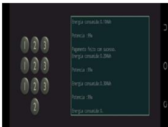
Fig. 11- Interface do medidor após o consumidor realizar a recarga. Fonte: (Próprio autor, 2024).
